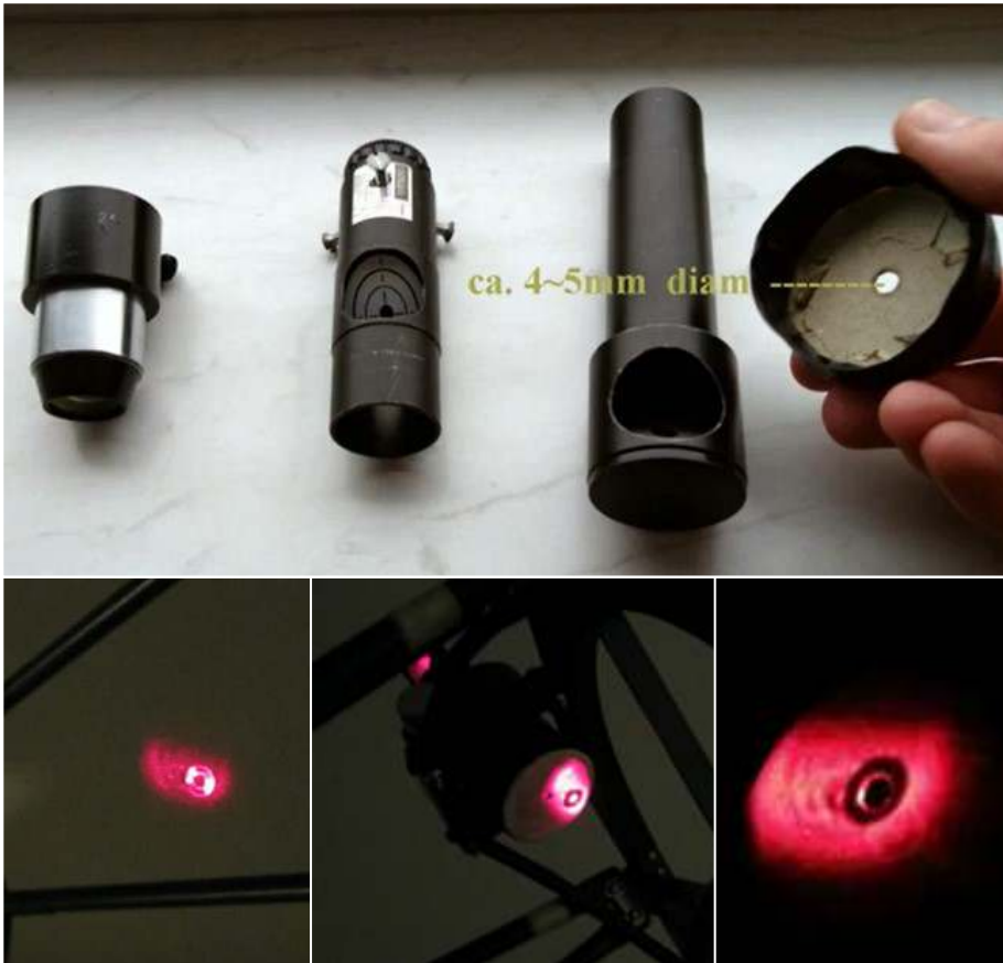
Afb. 9 - barlowed laser collimation. Onderste foto's v.l.n.r.: lichtbundel op hoofdspiegel, lichtbundel op wit vlak in focusser, juist gecollimeerd.
